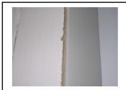
Diese unerwünschten Beschädigungen der Wellpappe bezeichnet man mit Rillplatzer. Durch sie kann die Funktion der aus der Wellpappe hergestellten Verpackung mehr oder weniger stark beeinträchtigt werden, auf jeden Fall stören Rillplatzer die Ästhetik und werden zu Recht von Abpackern nicht hingenommen.
